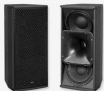
**Seeburg acoustic Line K20:** Das Hochleistungstopteil K 20 eignet sich aufgrund seiner Konstruktion für flexible Anwendungen in Vertikal- und Horizontalausrichtung. Die optimierte Anordnung und Ansteuerung der 2 x 10"/ 1.4, 800W, 40hm, 134dB, 70Hz - 18kHz, 90°x60°, Gewicht 22,5kg Maße 66x30x36 cm Flugfähig
