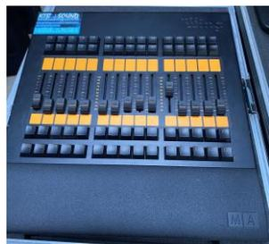
**MA 2 on PC fader Wing Hybridconsole Lichtsteuerung, gedacht als Faderwing oder als eigenständiges Fader Wing, 4xDMX OUT, USB**
