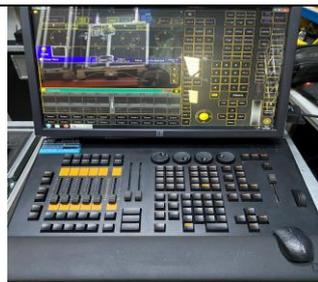
**MA 2 on PC Command Wing Hybridconsole Lichtsteuerung, Elotouch 22", Tastatur, Maus, 2-3 Interne DMX OUT, DMX IN, zusätz Display Anschlüsse, Netzwerk Anschluss, USB**
