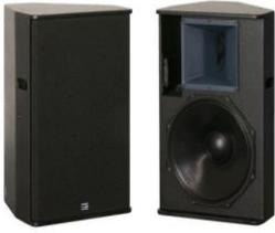
**Seeburg acoustic Line TSM 15:** TSM15 ist eine multifunktionale Lautsprecherbox der Oberklasse. Sie ist optimiert für Monitoranwendungen und kann aufgrund des drehbaren Hornes auch für klassische Fullrangeanwendungen oder für die Quermontage eingesetzt werden. Vielfältige Montagemöglichkeiten von Flugzubehör, 15"/2", 600W, 80hm, 131dB, 50 - 18kHz, 90°x60°, Gewicht 31 Kg, Maße 69,8x45,0x41,0 cm
