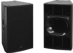
**Seeburg acoustic Line K24:** Das Hochleistungstopteil K 24 eignet sich aufgrund seiner Konstruktion für flexible Anwendungen in Vertikal- und Horizontalausrichtung. Die optimierte Anordnung und Ansteuerung der 2 x 12"/ 1.4, 800W, 40hm, 140dB, 75Hz - 15kHz, 90°x60°, Gewicht 37kg 70x42x46 cm Flugfähig
