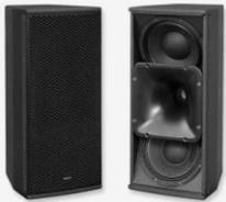
**Seeburg acoustic Line K20:** Das Hochleistungstopteil K 20 eignet sich aufgrund seiner Konstruktion für flexible Anwendungen in Vertikal- und Horizontalausrichtung. Die optimierte Anordnung und Ansteuerung der 2 x 10"/ 1.4, 800W, 40hm, 134dB, 70Hz - 18kHz, 90°x60°, Gewicht 22,5kg Maße 66x30x36 cm Flugfähig
